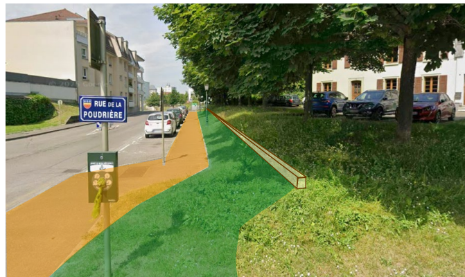
Possibilité d'implantation d'une piste cyclable ou trottoir mixte, rue Vauban (le léger soutènement ne devra pas empiéter sur le système racinaire des arbres, cependant)
