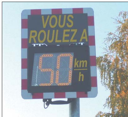
Richwiller : panneau dynamique indiquant en temps réel sa vitesse à l'automobiliste (source : m2A).
