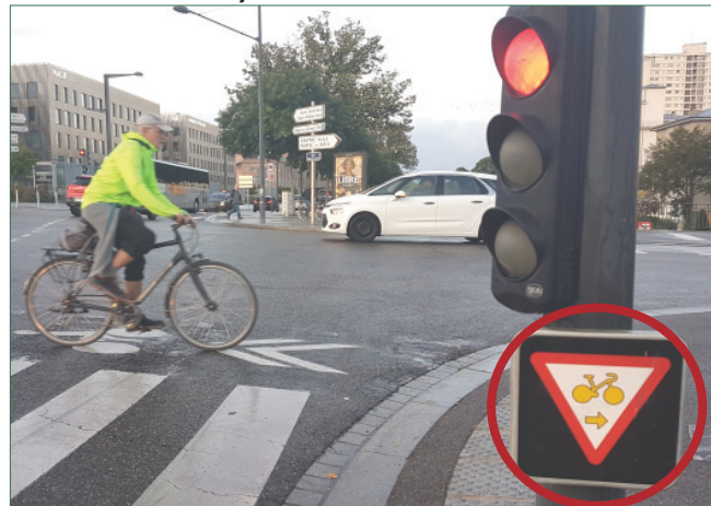
Mulhouse - Rue des bonnes Gens X Quai d'Alger : tourne à droite cyclable permet au vélo d'aller à droite même lorsque le feu est rouge.
