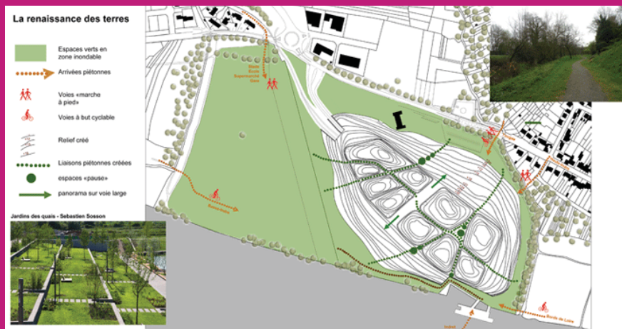
«Sol Fertile», une colline de dépollution des terres à Saint-Herblain. En surface, se retrouvent les espaces de déambulation et le stockage de la terre «propre». Sous les collines, se retrouvent les circulations ferroviaires, routières et fluviales. Elles desservent les différents bâtiments ferroviaires de traitement de la terre polluée (Source : Atelier prospectif par des étudiants de l'école d'architecture de Nantes)
