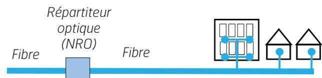
L'abonné dispose d'un réseau fibre de bout en bout. La fibre est tirée du NRO à l'intérieur du logement, jusqu'à la prise de raccordement de la box. La fibre optique est capable d'acheminer des débits allant de 100 Mbit/s à 1Gbit/s.
