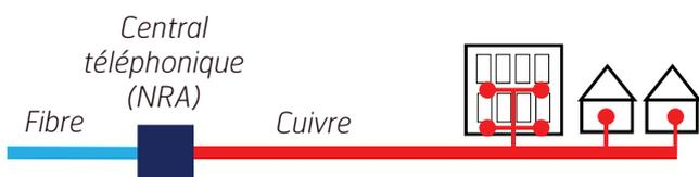
L'ADSL consiste à amener la fibre jusqu'à un central téléphonique (NRA) ou jusqu'au sous-répartiteur. Le flux d'informations passe ensuite par le réseau historique téléphonique cuivre. Cette technologie a vu le jour à la fin des années 1990. Plus un logement est éloigné du central téléphonique ou du sous-répartiteur, plus le débit s'affaiblit (forte baisse à partir de 2 km).
