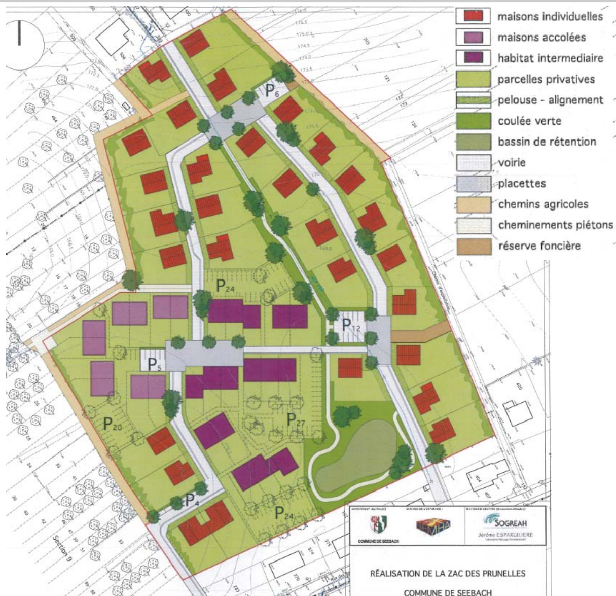
Un plan masse d'aménagement en phase avec celui des OAP (source : Jérôme Espargilière, pour l'aménageur Citivia)
