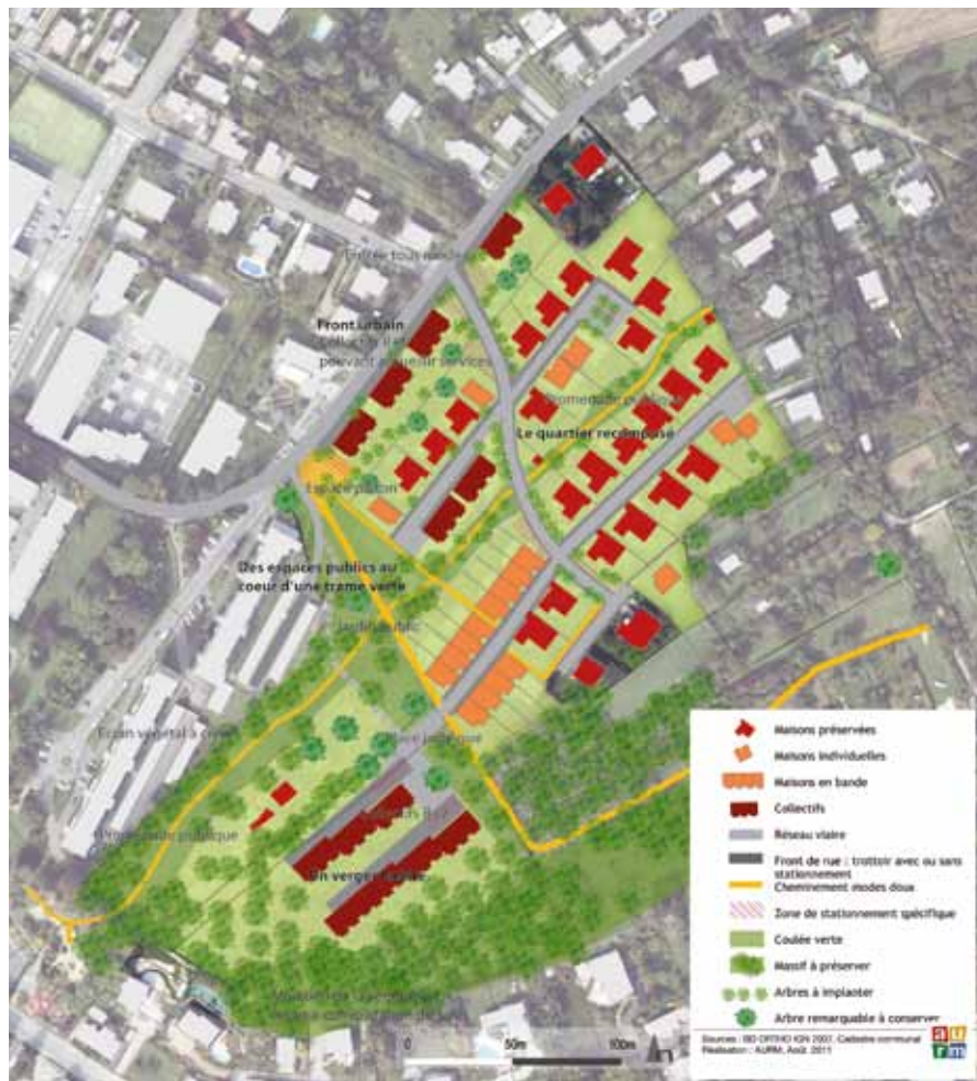
Le schéma d'aménagement propose une organisation autour de la structure viaire existante et un développement de la trame verte structurante. Il intègre une diversification partielle du site.
